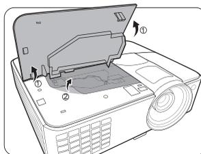
4. Desconecte el conector de la lámpara del proyector.
