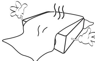
Si los orificios de ventilación están completamente obstruidos, el recalentamiento del proyector puede provocar un incendio.
