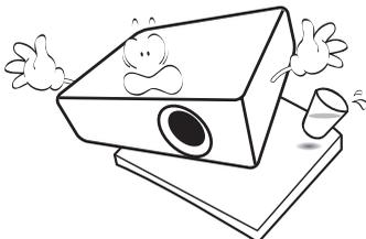
11. No intente reparar este proyector usted mismo. En su interior hay piezas de alto voltaje que pueden causar la muerte si las toca mientras están en funcionamiento. La única pieza que puede ser manipulada por el usuario es la lámpara, ya que dispone de su propia cubierta extraíble.
