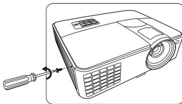
3. Retire la cubierta de la lámpara del proyector.
